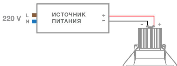
Схема подключения группы светильников к одному источнику питания
